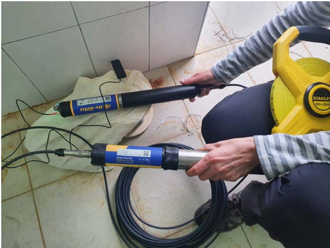
Slika 2.3-5. Multiparametarski automatski čitači Aqua Troll 500 tvrtke In situ s telemetrijskim očitanjem
